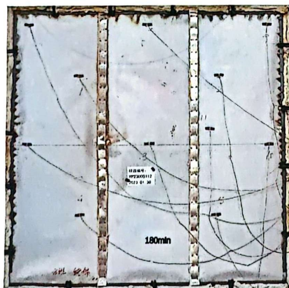
照片 2 耐火试验结束时试件情况
